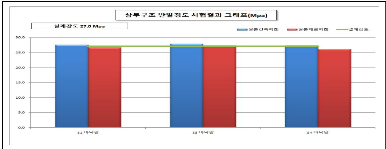
【그림 25.4.2】 상주방향 상부구조 반발경도시험 측정결과
